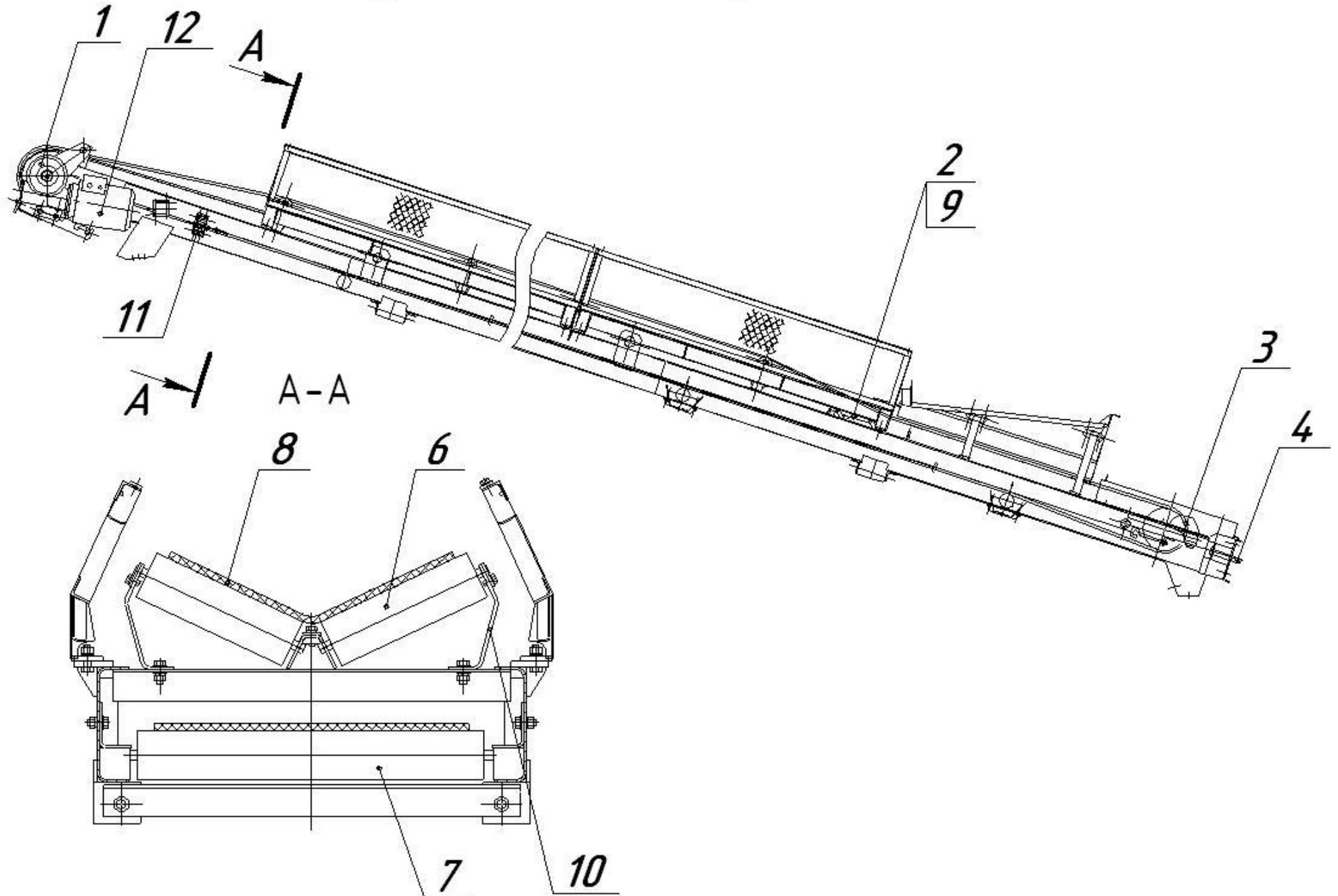
**КДМ201 00.10.000 Конвейер наклонный**
