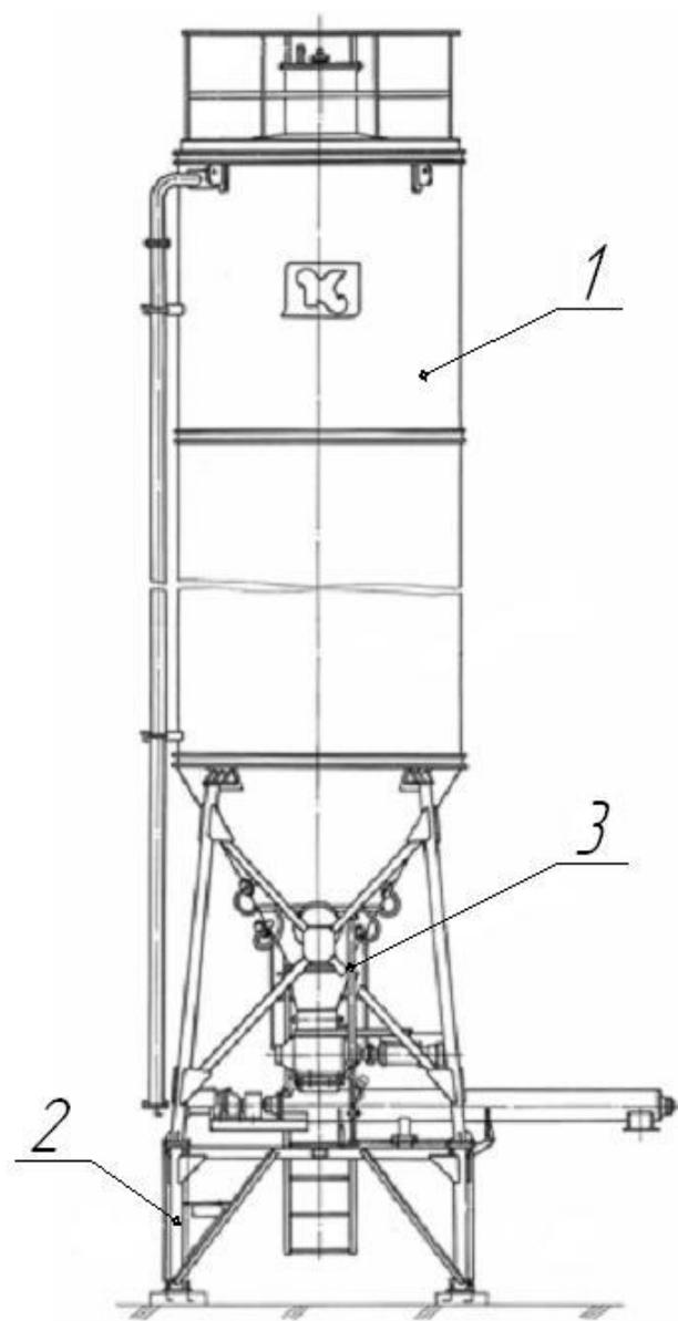
*КДМ2013 72.00.000 Агрегат минерального порошка*
