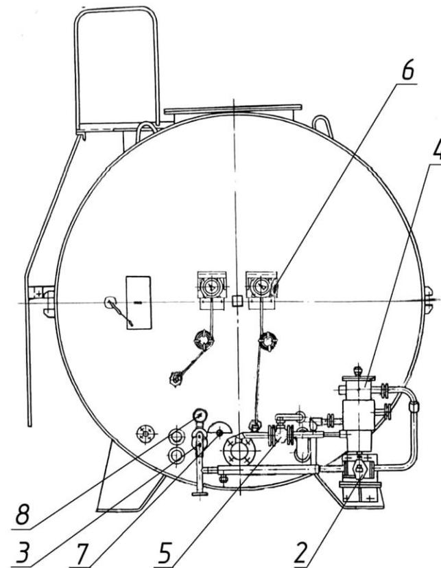
*ДС-168 02.00.000 Емкость топливная.*
