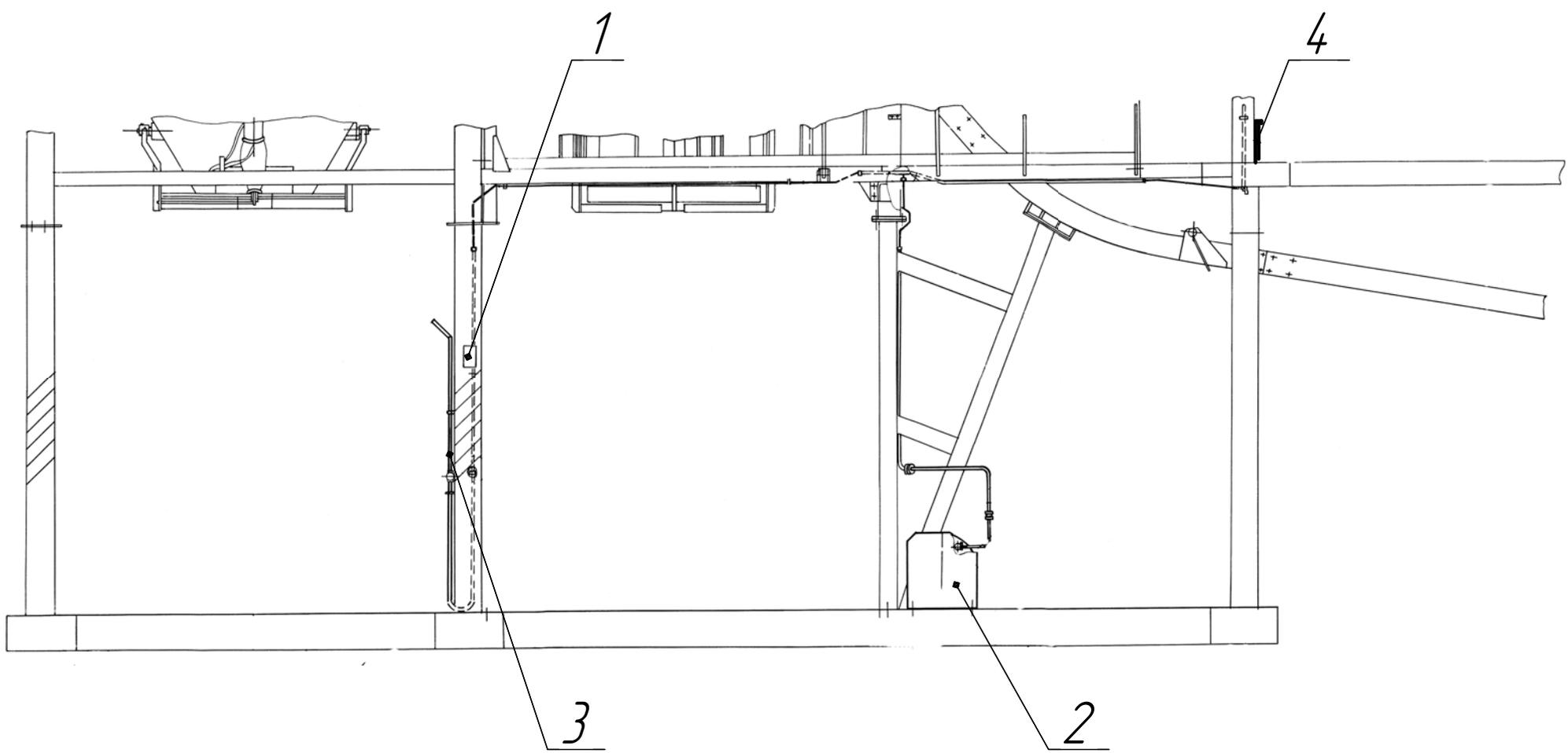
*ДС1857 00.07.000 Система опрыскивания*
