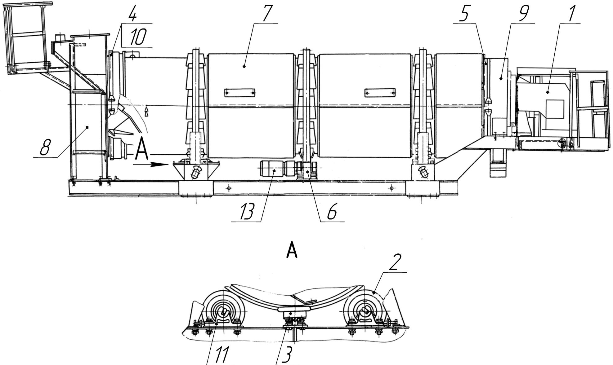
*ДС-18561 21.40.000 Установка сушильного барабана.*
