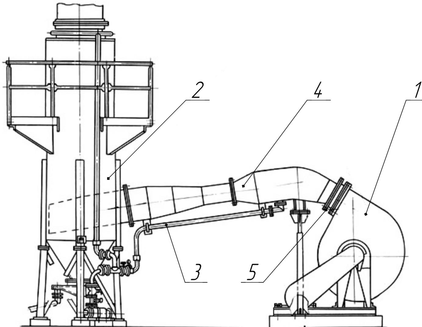
*ДС-18561 27.00.000 Агрегат мокрой газоочистки.*
