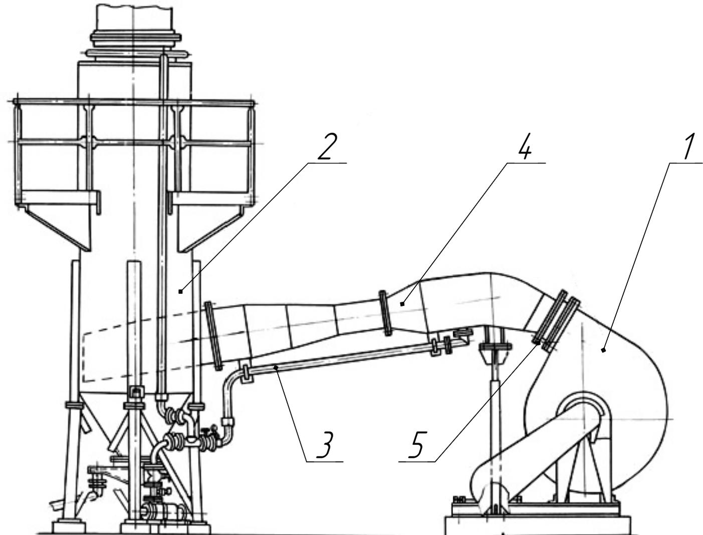
*ДС-185 27.00.000 Агрегат мокрой газоочистки.*
